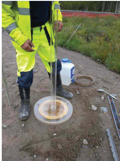
Figur 17. Stor vattenvolymeter utvecklad i forskningsprojektet. Bestämning av densitet för bankmaterialet.
