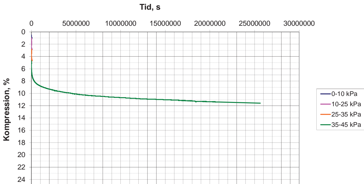
Figur 86. Resultat från ett krypförsök utfört i stegvisa ödometerutrustningen, borrhål SGI 46 djup 3 m, linjär skala, jämför med Figur 85.
