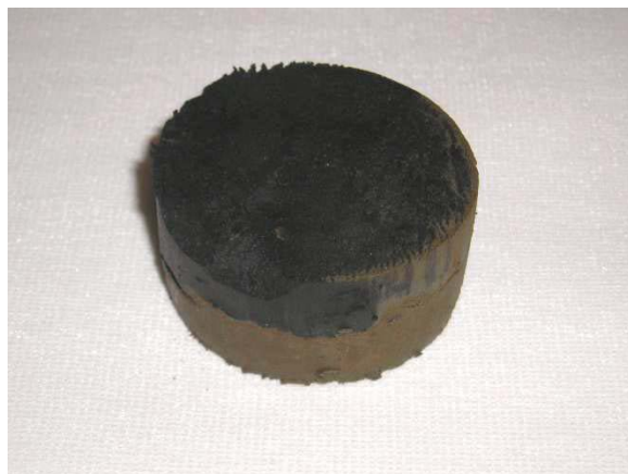
Figur 4. Ett exempel på svart och relativt homogen sulfidjord som har utsatts för oxidation (syre) på mantelytan, (Westerberg & Andersson, 2009).
