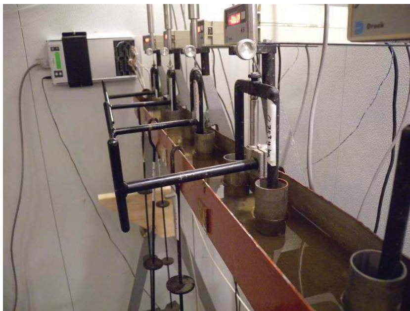
Figur 24. Överdelen av ödometerutrustningarna. (Utrustningen var här inte i ordningsställd för försök, dvs. det pågick inga försök.)
