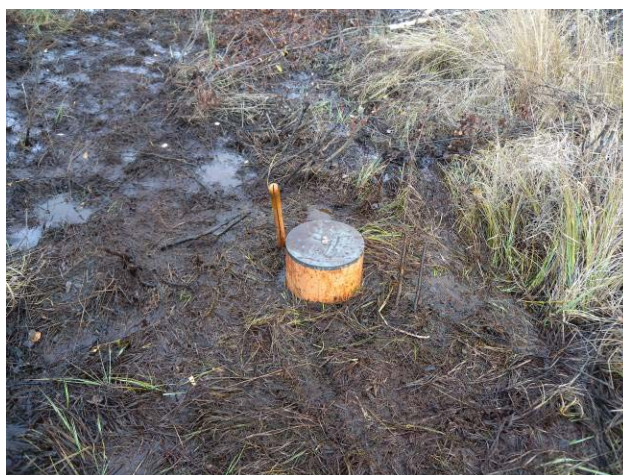
Figur 14. Upptagning av torvprov. Bilden visar när plaströret är nedpressat genom torvlagret och till vänster syns sticksågen som användes vid nedpressning.
