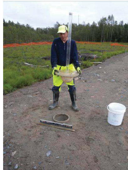
Figur 17. Stor vattenvolymeter utvecklad i forskningsprojektet. Bestämning av densitet för bankmaterialet.
