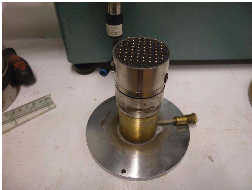
Figur 28. Filtersten med 3 mm höga piggar som användes vid utförda odränerade direkta skjuvförsök.
