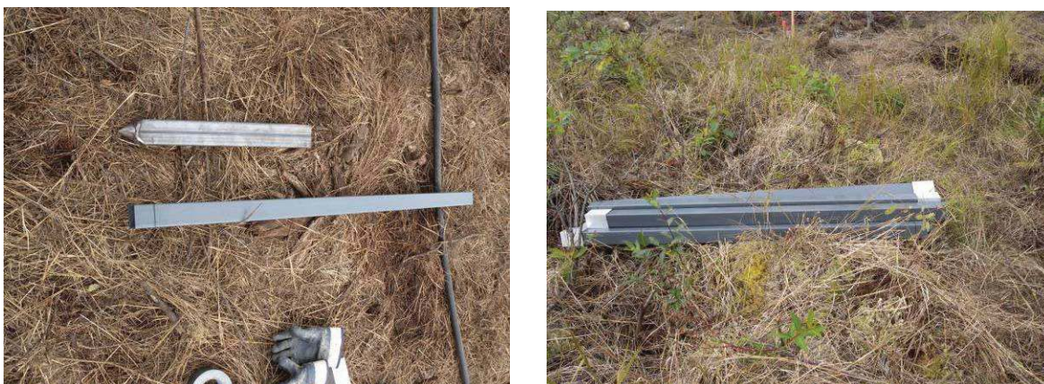
Figur 40. Till vänster i bilden syns ett fyrkantströr i plast inklusive bergsko i stål och till höger i bilden flera fyrkantströr med skarvhylsor av aluminium.
