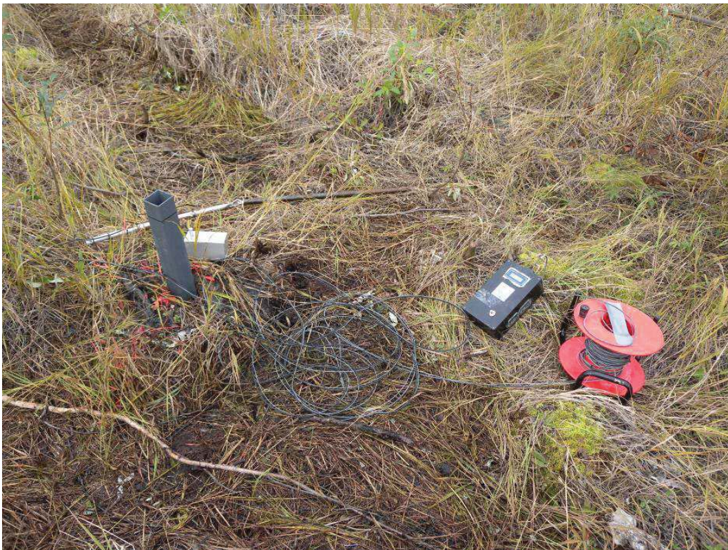
Figur 42. Mätutrustning för fyrkantsinklinometer.
