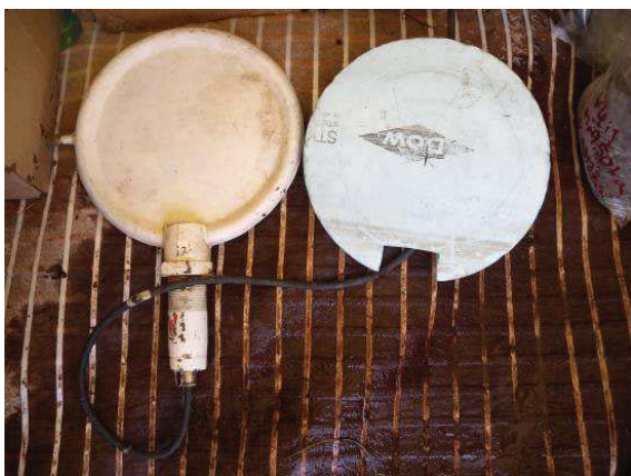
Figur 43. Till vänster i figuren visas en av de installerade marktrycksgivarna av typ Freyssinet med en passande skiva cellplast. Till höger i figuren visas en installation av en marktrycksgivare, där själva plattan är omgiven av två ihoptejpad cellplastskivor vilket bäddas in i ett skyddande sandlager.
