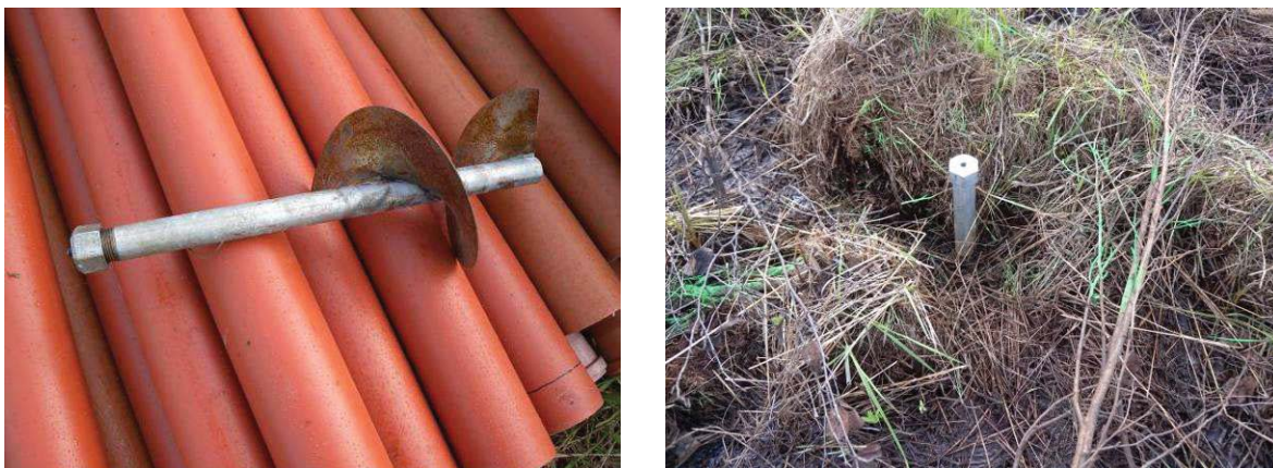
Figur 36. Till vänster visas en bild på en markpegel före installation och till höger visas en färdiginstallerad markpegel.
