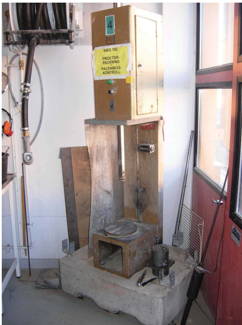
Figur 29. Proctorutrustning som användes vid packning av bankmaterialet.
