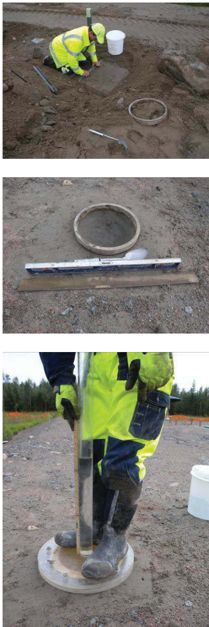
Figur 18. Utförande av densitetsbestämning med hjälp av en stor vattenvolymeter. I översta bilden visas hur provytan jämnades till och vägdes av med vattenpass. Mitten bilden visar den använda utrustningen (stålring, sked, vattenpass och plattjärn) och i den nedersta bilden visas hur provgropens volym bestämdes med hjälp av tumstock (meter vattenpelare i röret).
