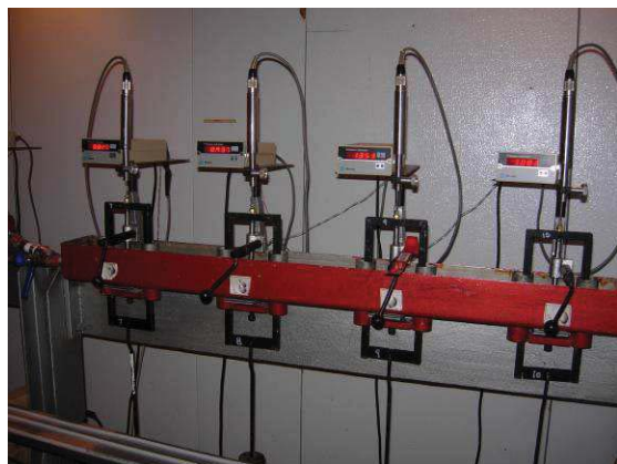
Figur 22. Försökupställning för ödometerförsök, standard stegvisa, av- och pålastning och krypförsök.
