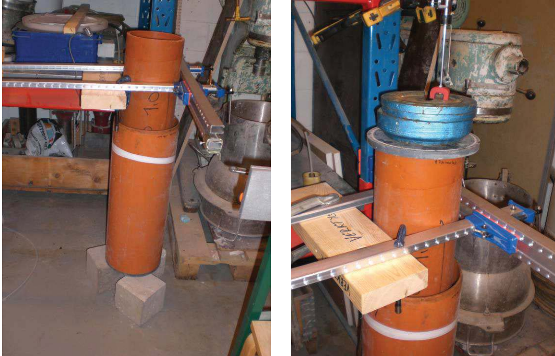
Figur 31. Försöksupställning för ett kompressionsförsök på torv. Till vänster visas röret i vilket torvprovet är placerat och till höger visas provet belastad med 5 kPa, ovanpå lasterna syns även den monterade LVDT-givaren som använts för kompressionsmätning.
